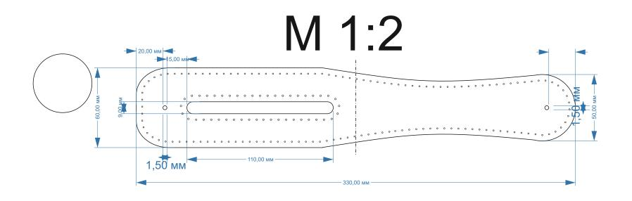
Кожа толщиной 1,6—1,8 плотная Молния #3 12см с запасом 1 кнопка Вид пробойника любой
