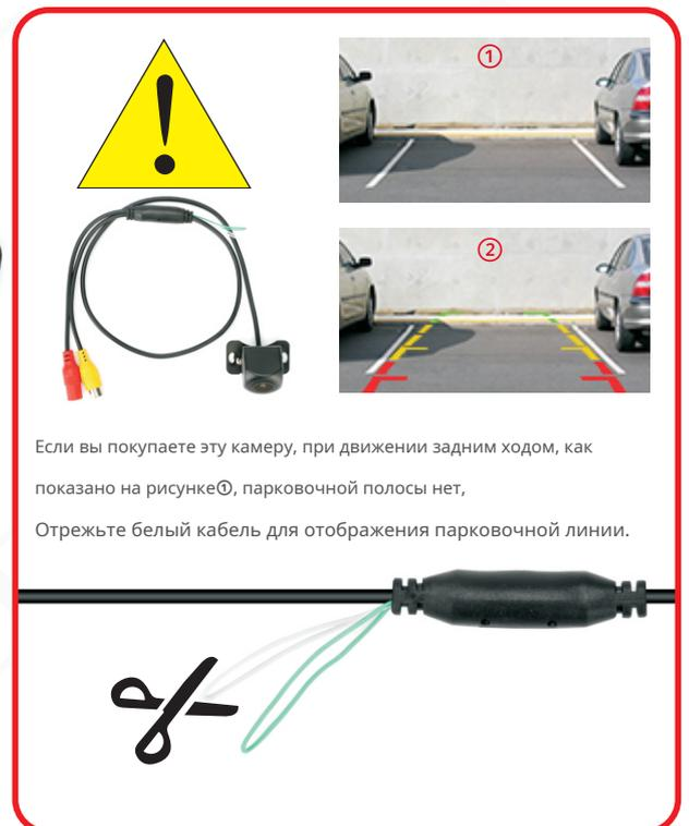
Это принцип подключения задней камеры. В большинстве случаев это можно выполнить, напрямую подключив линию триггера Back (Reverse).
